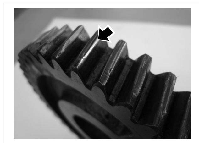
Engrenagem com dentes amassados
