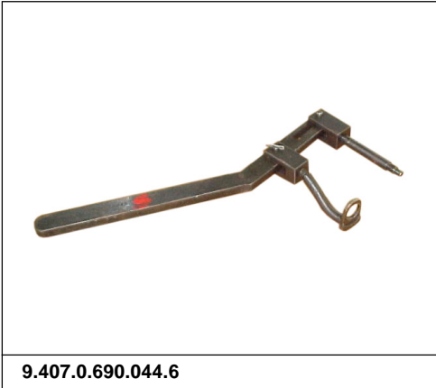
DISPOSITIVO PARA DESMONTAGEM E MONTAGEM DAS MOLAS DAS VÁLVULAS
