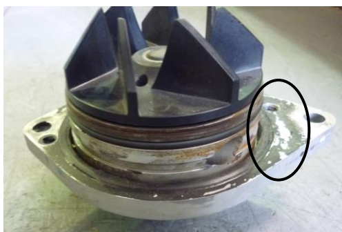
2 - Bomba d'água do motor Série 12 com sinais de uso de selante
