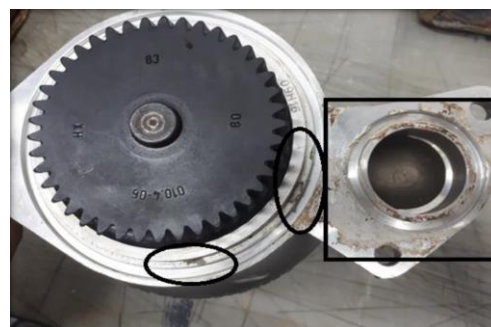
3 - Bomba d'água do motor Sprint com sinais de uso de selante
