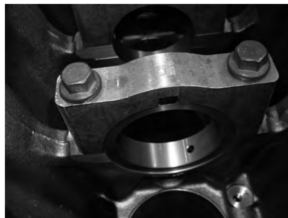
Capa de mancal sinterizada Parafuso: M14x95 – Classe 10.9
